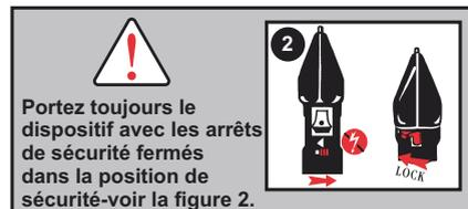
Portez toujours le dispositif avec les arrêts de sécurité fermés dans la position de sécurité-voir la figure 2.
